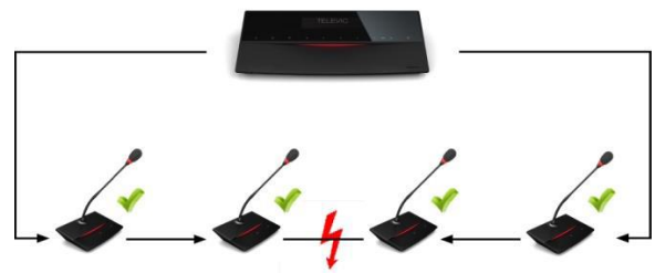
图5.4: D-Cerno 环路连接 (环路有错)
