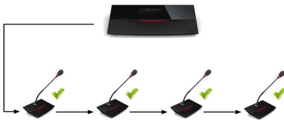
图5.2 : D-Cerno 支路连接 (无错发生)
