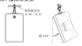
注 为了防止设备坠落,如图所示安装安全线缆。
